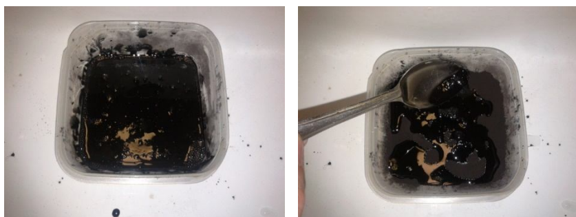
Рис. 1. Этапы приготовления ферромагнитной жидкости.
